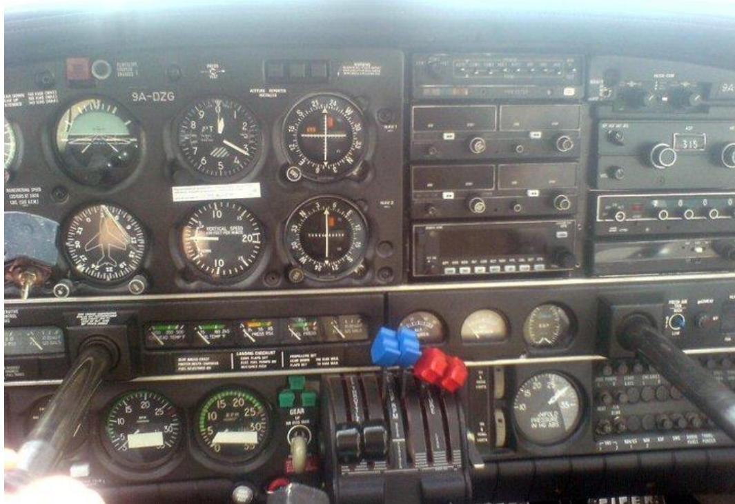
Slika 10. Cockpit zrakoplova PA-44, motorski instrumenti i poluge za upravljanje motorom
