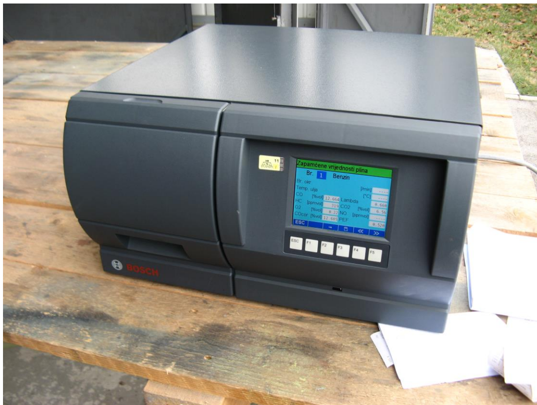
Slika 9. - Uređaj za analizu ispušnih plinove otto motora Bosch Bea-350
