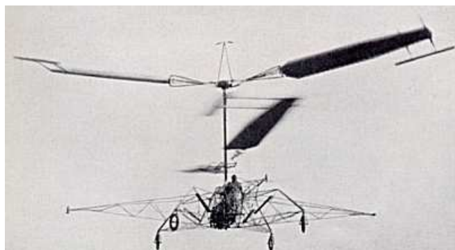
Slika 1.3. Koaksijalni rotori helikoptera koji je konstruirao Corradino d'Ascanio
