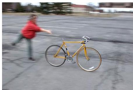
Slika 3.67. Dinamička samostabilnost bicikla
