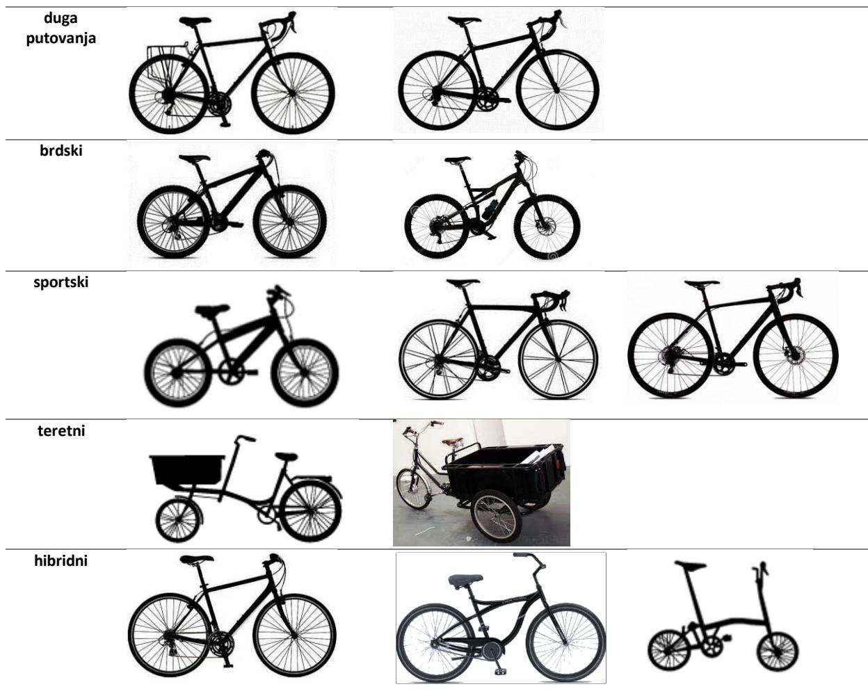
Bicikli mogu biti pokrenuti isključivo ljudskom snagom, ljudskom snagom i pomoćnim motorom ili samo električnim motorom.
