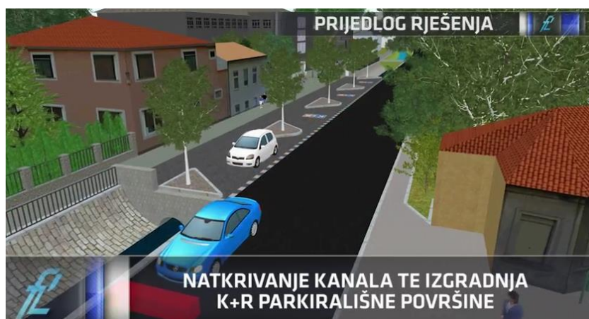
Slika 60. Simulacija prijedloga poboljšanja sigurnosti prometa natkrivanjem kanala i izgradnjom K+R parkirališne površine
