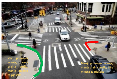
Slika 50. Utjecaj polumjera zavoja na brzinu vozila
