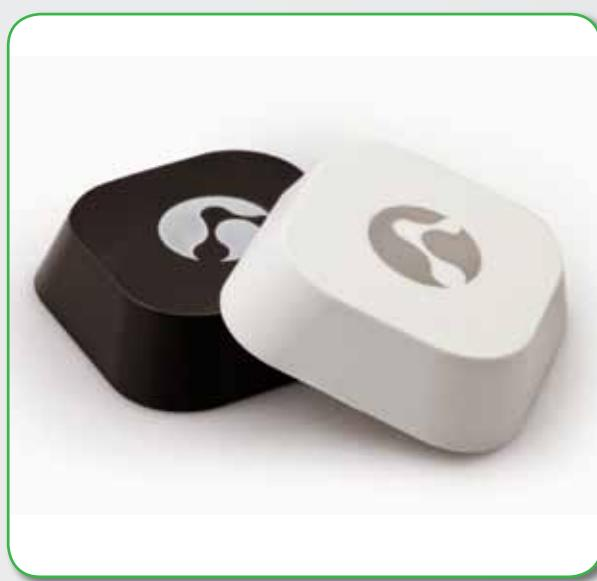
Uredaji se koriste za identifikaciju objekata koji svojim specifikacijama mogu raditi za udaljenosti do 70 [m], otporan je na sve vremenske uvjete te pogodan za vanjsku primjenu. Tehnologija povezivanja koja se koristi je Bluetooth 4.0 (BLE) kojom su danas opremljeni noviji mobilni terminalni uređaji neovisno o operativnom sustavu (Android ili iOS). Uz navedene uređaje moguće je koristiti i CMS za upravljanje s radom beaconsa.
