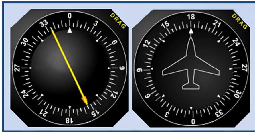
Slika 10. Prikaz RBI (lijevo) i DG (desno) za primjer 2.
