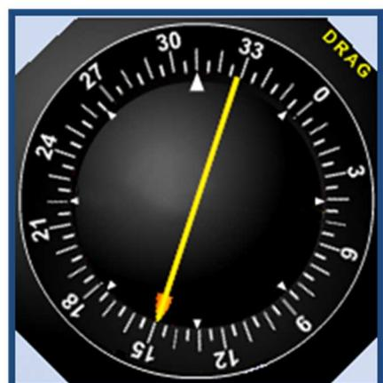
Slika 4. Radio-magnetski prikaznik (reducirani prikaz)
