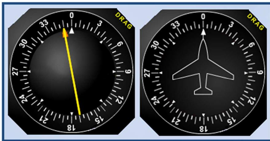
Slika 8. Prikaz RBI (lijevo) i DG (desno) za primjer 1.
