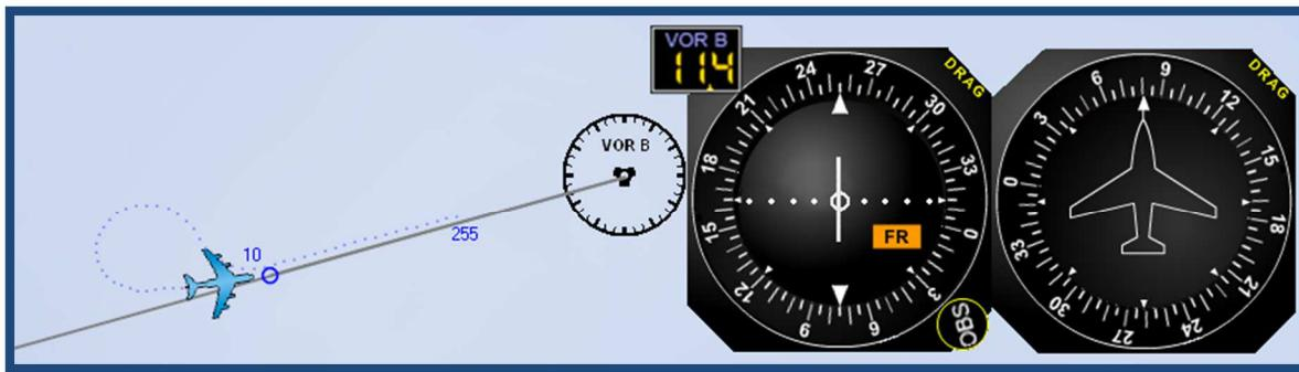
Slika 64. Proceduralni zaokret  $80^\circ/260^\circ$  za primjer 23.
