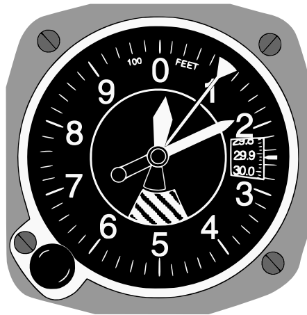
Slika 9. Analogni prikaznik mehaničkog OBV-a
