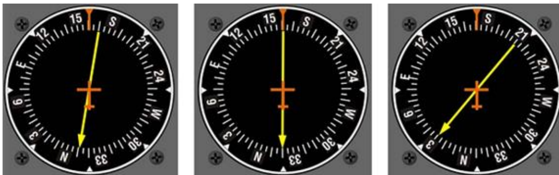
Slika 15. Primjer prikaza prikaznika RMI
