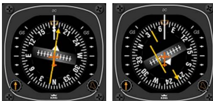
Slika 17. Primjer prikaza prikaznika HSI
