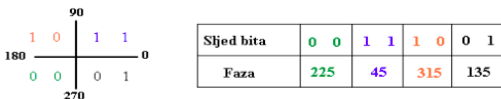
Slika 5: Slijed bita u odnosu na fazni pomak
